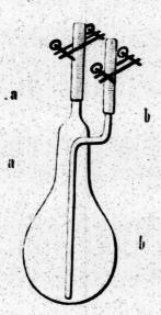
Es sind Literkolben von beistehender Figur. In den Hals derselben ist das 2 Mal rechtwinklig gebogene Rohr b eingeschmolzen, das im Innern bis ziemlich auf den Boden des Kolbens reicht und über dessen äussere Mündung, ebenso wie über diejenige des oben verjüngten Halses a, ein festschliessendes Kautschukröhrchen gezogen ist, welches sich durch eine Klemme luftdicht verschliessn lässt. Während des Kochens wird die Klemme über b verschlossen und nur die über a be-
