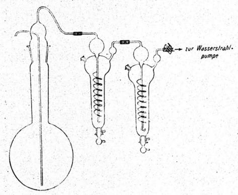
ebenso gefüllt an die erste angeschlossen, um eventuell entweichendes Halogen zurückzuhalten; bei richtiger Handhabung enthält die letztere Flasche kaum wägbare Mengen Halogensilbers. Zur Veraschung wird Mercksche «Schwefelsäure, mit rauchender Schwefelsäure für Kjeldahl-Bestimmung» gebraucht, der pro 250 ccm 10 g Kupfersulfat und 80 g Kaliumsulfat zugesetzt werden. Die Schwefelsäure wird in obigem
