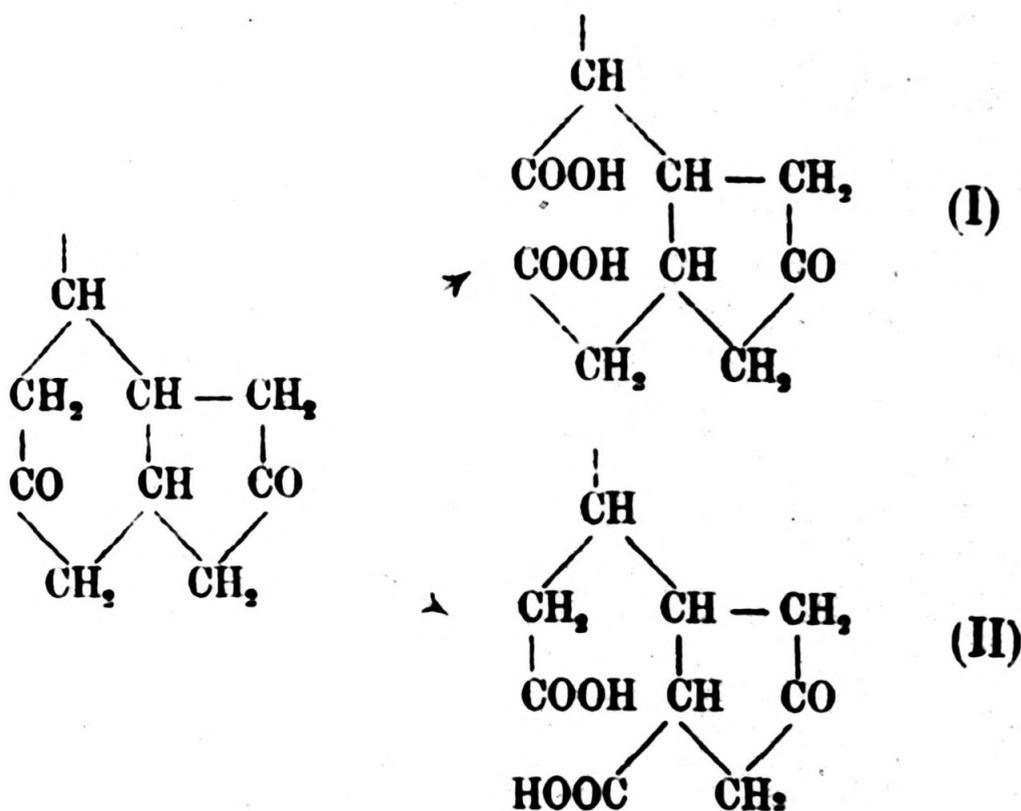
Bei der Vakuumdestillation werden aus diesen beiden Dicarbonsäuresystemen zwei isomere, aber verschiedene Fünfringketongruppen hervorgehen. In der Tat pflanzt sich die Isomerie auf die Brenzsäuren fort (vgl. S. 300 der vorher-
