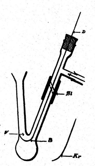
Ende der Reaktion, zu einer Verstopfung des aufsteigenden Schenkels des Quarzkölbchens.
