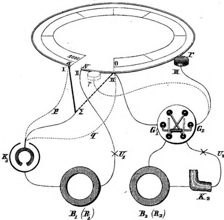
Platindraht des Compensators (Nebenschliessdraht),  $r$  das Platinröllchen des Instrumentes,  $G_1 G_2$  ein Stromwender, etwa ein POHL'scher
